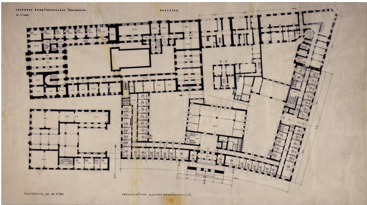
Abb. 16, Grundriss der Gesamtanlage mit Landhaus, Taxispalais und Erweiterungsbau mit Wirtschaftstrakt, EG, 25.4.1939 (Registratur der Liegenschaftsverwaltung).
